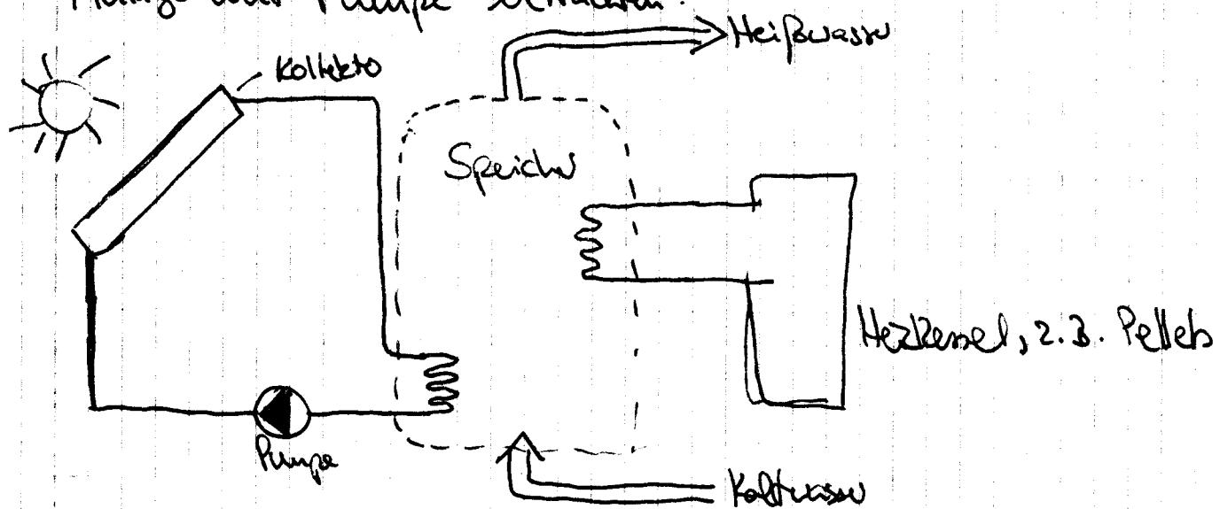
Hierbei wird das heiße Wasser in einem 200l~1500l Wasserspeicher gesammelt. Die Pumpe zum Kollektor schaltet sich dann ein, wenn die Temperatur im Kollektor um 5-10° C übersteigt.
